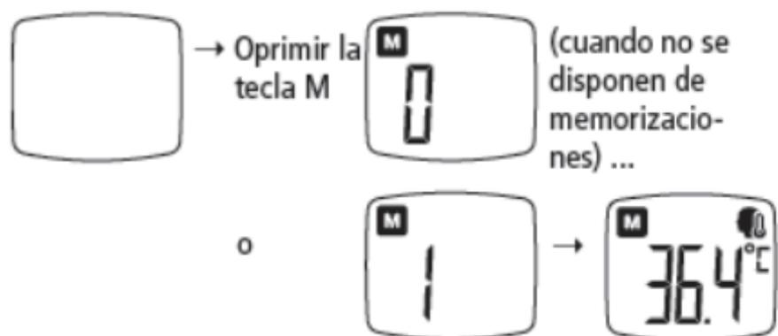
2. Oprima varias veces de forma breve y sucesiva la tecla M para cambiar a un resultado de medición determinado memorizado.
