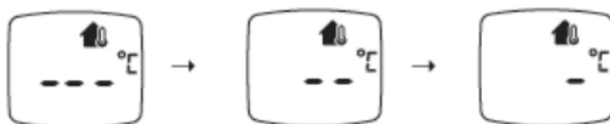
4. Non appena la misurazione è conclusa viene emesso un segnale acustico lungo e viene visualizzato il risultato.
