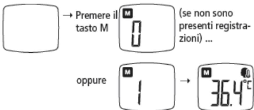
2. Premere brevemente il tasto M più volte una dietro l'altra per passare ad un determinato risultato di misurazione registrato.
