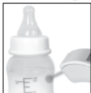
3. Dès que le bosotherm diagnostic se trouve dans la bonne position, appuyez sur la touche START afin d'effectuer une mesure de la température de l'objet. La prise de mesure dure environ une seconde. Sur l'écran, il est indiqué que la prise de mesure est en cours.
