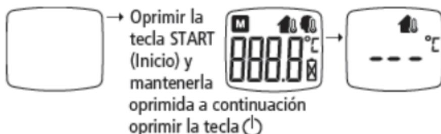
2. Para medir la temperatura de un objeto sujete el dispositivo a una distancia de unos 5 cm (o menos) de la superficie del objeto, de manera que el sensor señale en dirección del objeto.
