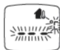
7. Oprima la tecla
