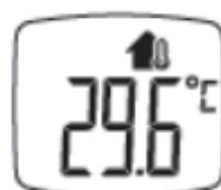
6. Si la medición suministra un resultado que se encuentra por encima o por debajo del rango de temperatura para este modo, se indica "H" o "L" en el display y se producen 3 tonos cortos de señal. Tras unos 5 segundos bosotherm diagnostic está nuevamente disponible para la medición.
