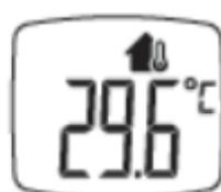
5. Al termine della misurazione della temperatura, il bosotherm diagnostic indica il risultato in modo permanente e si spegne dopo 1 minuto. Non appena l'apparecchio è pronto per una nuova misurazione, emette un segnale acustico breve e inizia a lampeggiare il simbolo „°C”. Per eseguire una nuova misurazione premere il tasto START e il bosotherm diagnostic inizia la misurazione.
