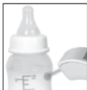
3. Non appena il bosotherm diagnostic si trova nella posizione giusta, premere il tasto START per misurare la temperatura dell'oggetto. La misurazione dura circa un secondo. Sul display viene indicato che la misurazione è in corso.
